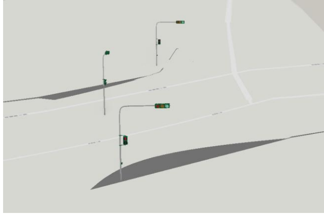
圖 4-22 號誌方向調整後圖示
