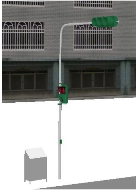
圖 4-20 行人行車號誌共桿、號誌控制箱示意圖
